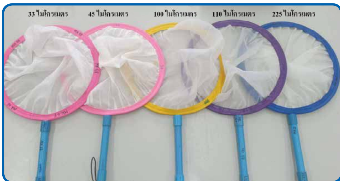
ภาพที่ 10-1 สaringanผ้ากรองขนาดตาถี่ 33-225 ไมโครเมตร สำหรับใช้ในการคัดแยกโคฟีพอด A. royi AMBT201601
