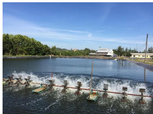
ภาพที่ 3 ใบพัดตีน้ำภายในบ่อเลี้ยงสัตว์น้ำของศูนย์วิจัยเทคโนโลยีทางทะเล
