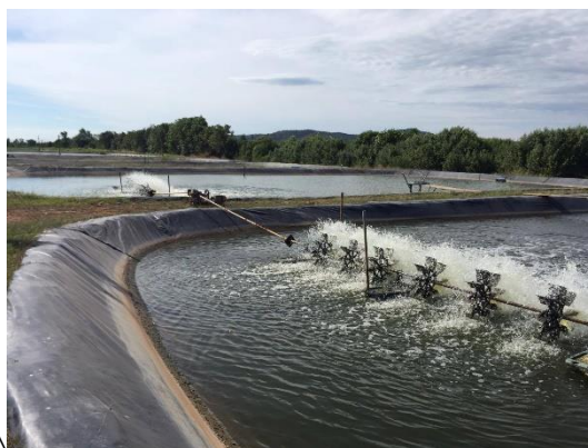
ภาพที่ 3 ใบพัดตีน้ำภายในบ่อเลี้ยงสัตว์น้ำของศูนย์วิจัยเทคโนโลยีทางทะเล
